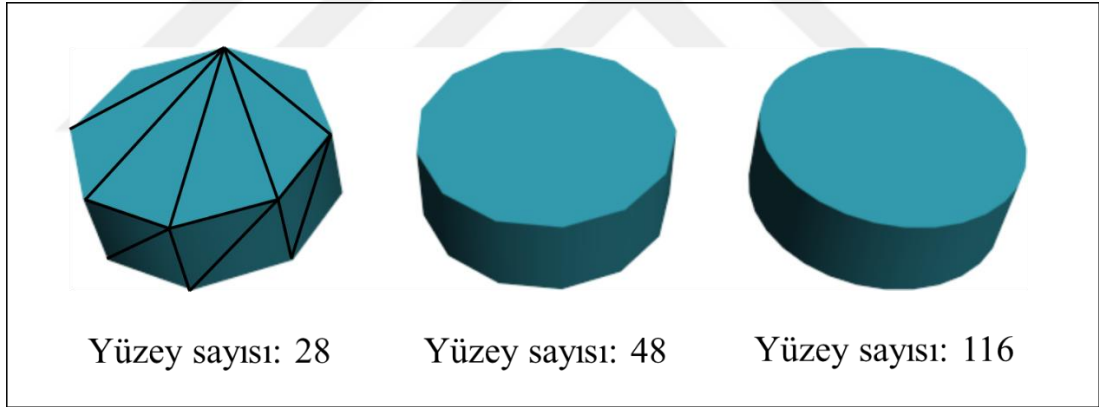
Şekil 5. 3 Boyutlu Obje Detay Seviyeleri
