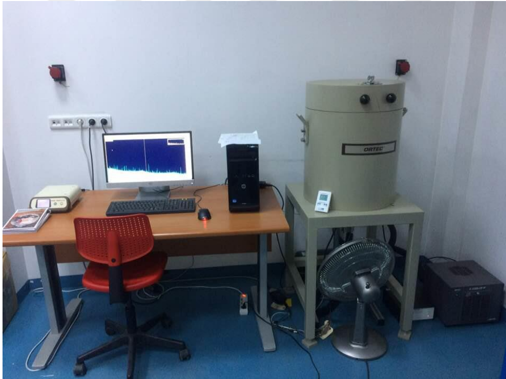
Şekil 3.6: İstanbul Üniversitesi Fen Fakültesi Fizik Bölümü Nükleer Fizik Anabilim Dalı Nükleer Fizik Araştırma Laboratuvarında bulunan gama spektroskopisi ölçüm sistemi.
