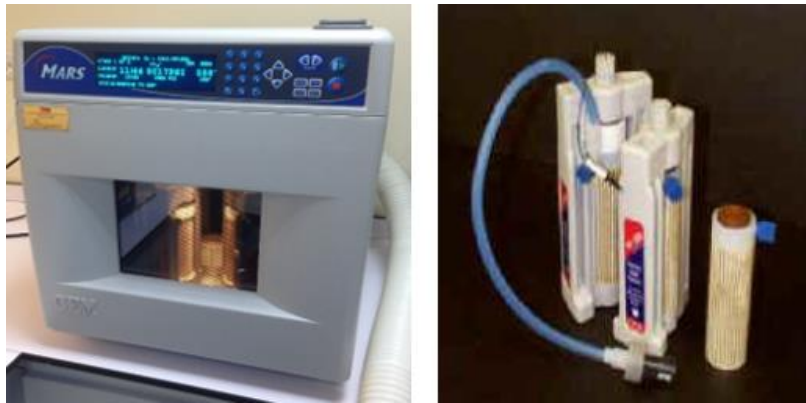
Şekil 3.18: MARS5 cihazı, kontrol tüpü, basınç ve sıcaklık sensörü.
