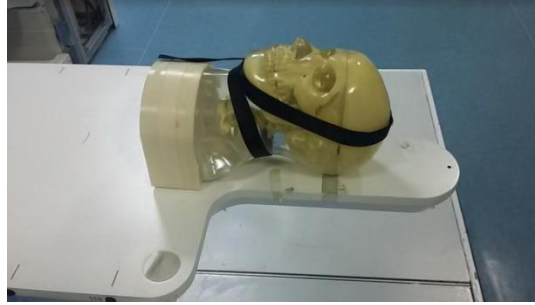
Şekil 3-17 Cyberknife baş-boyun fantomunun Cyberknife tedavi cihazında konumlandırılması
