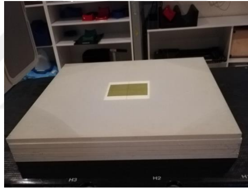
Şekil 3-22 Gafkromik EBT3 filmin katı su fantomu içerisine yerleştirilmesi
