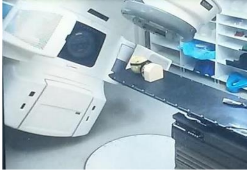
Şekil 3-20 Cyberknife baş-boyun fantomunun Varian DHX cihazında ışınlanması
