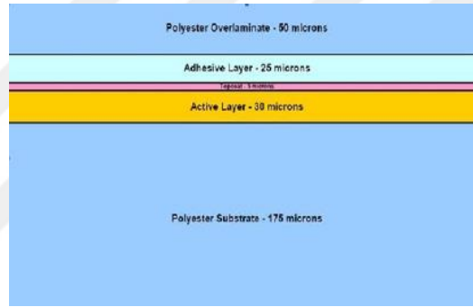
Şekil3-7 Gafchromic® EBT3 Film İç Yapısı
