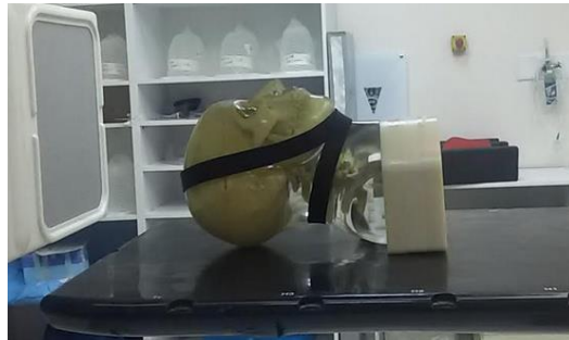
Şekil 3-19 Cyberknife baş-boyun fantomunun Varian DHX cihazında yatırılışı
