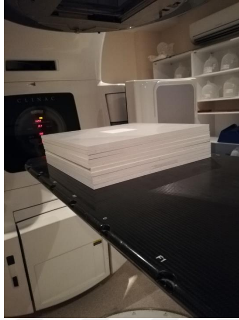
Şekil 3-21 Kalite kontrol işleminde kullanılan katı su fantomu
