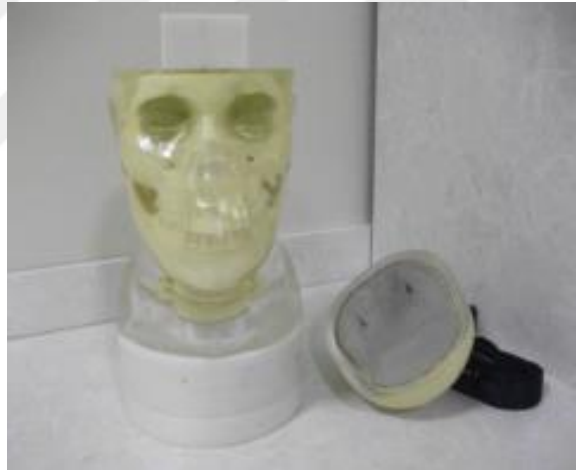
Şekil 3-9 Simülasyon işlemi için kullanılan Cyberknife fantomu
