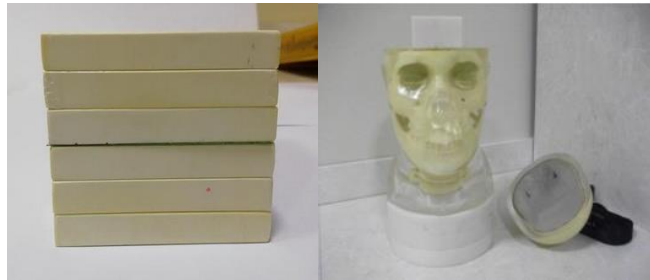
Şekil 3-16 Işınlanma esnasında filmlerin yerleştirildiği fantom
