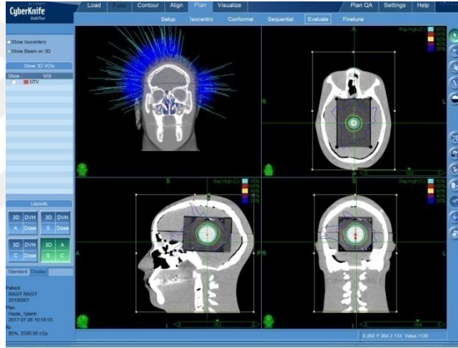
Şekil 3-5 Multiplan 4.5.3 sisteminde intrakranyal tedavi planlaması
