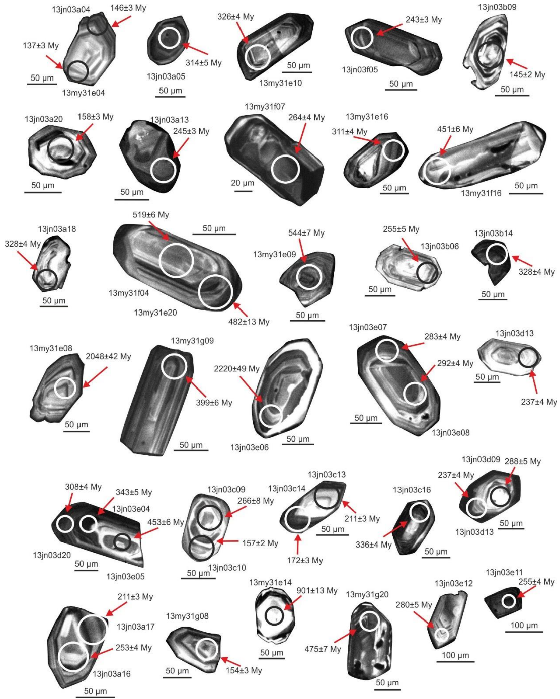
Şekil 4. 170: Sarpun Metamorfiti'ne ait bir kuvars-mikaşist örneğinde yaşlandırılan yarı özşekilli zirkonların katedolüminesans (CL) görüntüleri. Siyah ve beyaz daireler, ölçülen noktaları göstermektedir. 1 milyar yıldan yaşlı zirkonlar için ^{207}\text{Pb}/^{206}\text{Pb} değerleri kullanılmıştır.
