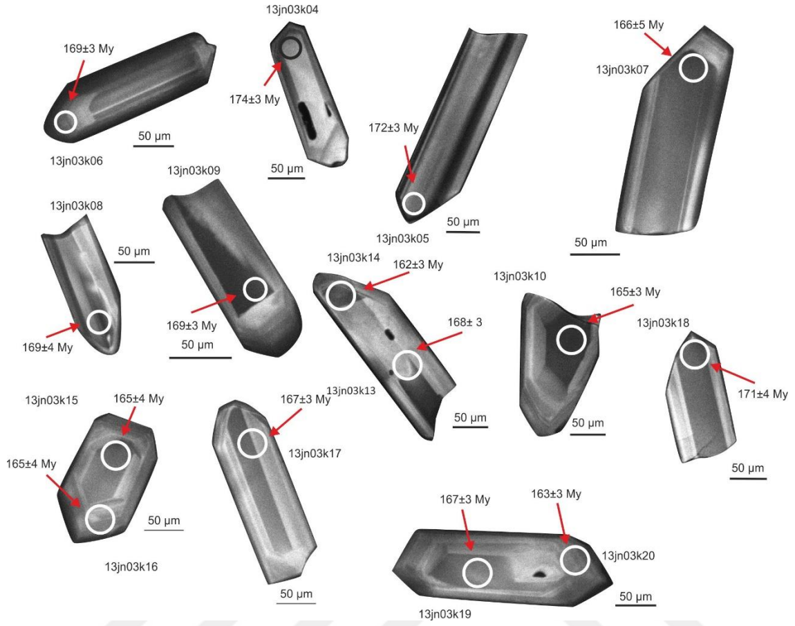
Şekil 4. 183: Kayadibi Plütönu'na ait bir diyorit örneğinde yaşlandırılan zirkonların katedolüminesans (CL) görüntüleri. Örnek no: 12-01. Siyah ve beyaz daireler, ölçülen noktaları göstermektedir.
