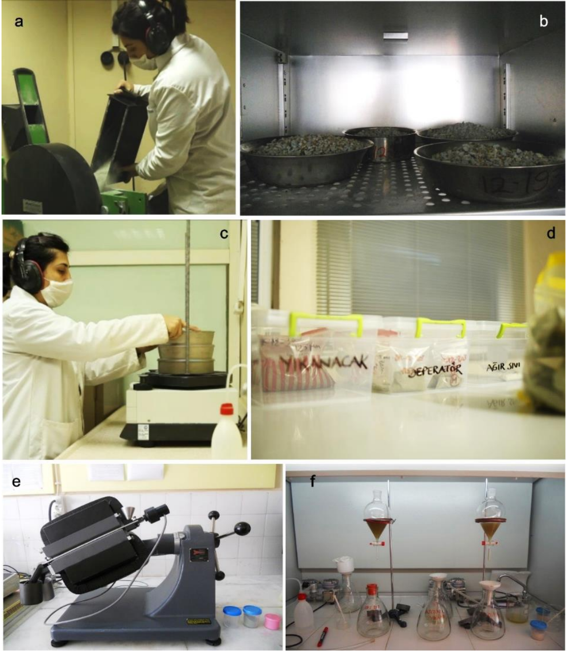
Şekil 3. 8: a. Örneklerin çeneli kırıcıda kırılması. b. Kırılıp yıkanan örneklerin etüvde kurutulması. c. Kuruyan örneklerin sarsıntılı masa üzerinde farklı elek boylarında ayrılması. d. Mineral ayırmanın farklı aşamalarında örnekler. e. Örneklerin manyetik separatórde manyetik ve non-manyetik fazlara ayrılması. f. SPT (Sodium Polytungstat) içinde zirkonları çökeltilen örnekler.
