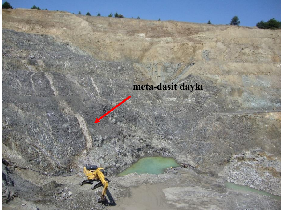
Şekil 5. 5: Devrekâni-Örenbaşı Köyü batısında açılmış krom ocağı mostralarında, metaofiyolitleri kesen dasitik dayk.
