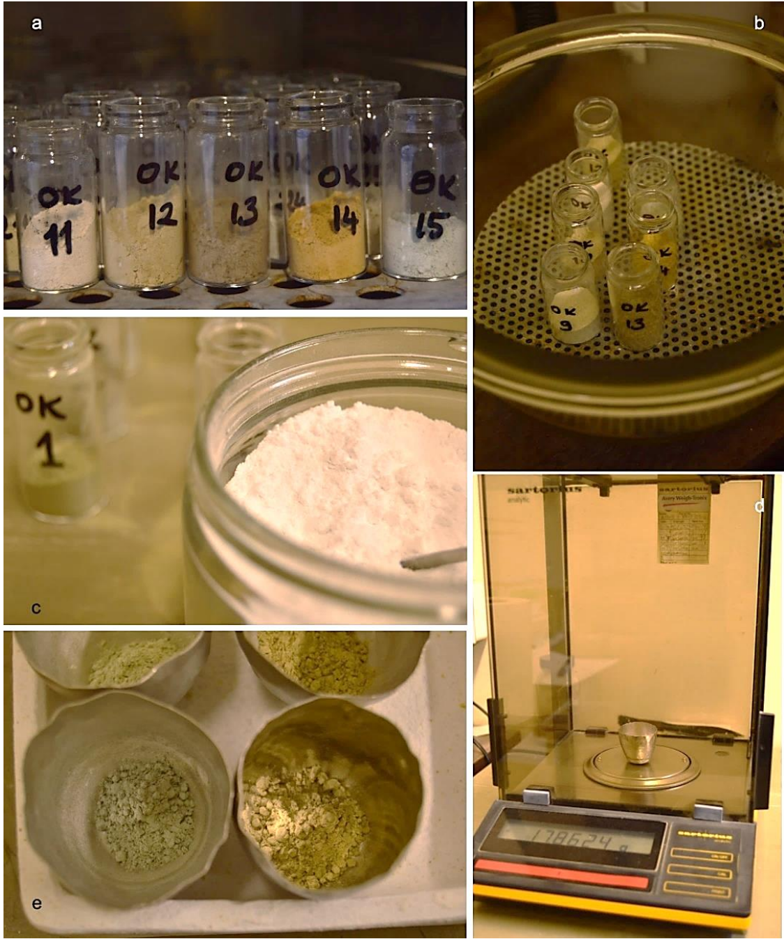
Şekil 3.3: XRF analizi için cam disklerin hazırlanması. a. Etüvde 1 gece bekletilmiş örnekler. b. Örneklerin desikatörde soğutulması. c. Cam disklerin hazırlanmasında kullanılan spectroflux tozu. d. Boş platin krozelerin tartımı. e. Platin krozeler içinde 0.9-1.0 g arasında tartılan örnekler.
