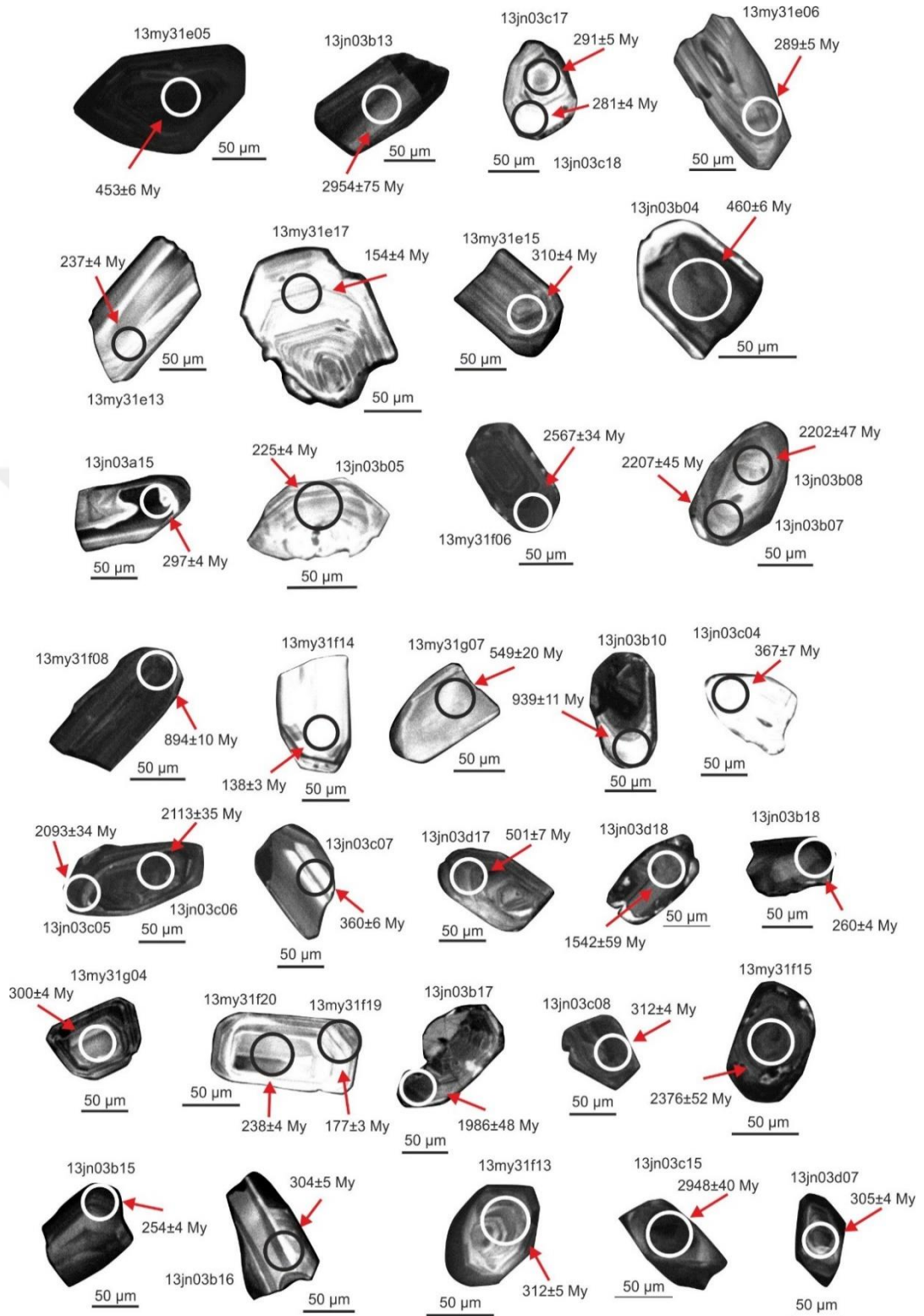
Şekil 4. 169: Sarpun Metamorfiti'ne ait bir kuvars-mikaşist örneğinde yaşlandırılan yarı yuvarlaklaşmış zirkonların katedolüminesans (CL) görüntüleri. Siyah ve beyaz daireler, ölçülen noktaları göstermektedir. 1 milyar yıldan yaşlı zirkonlar için ^{207}\text{Pb}/^{206}\text{Pb} değerleri kullanılmıştır.
