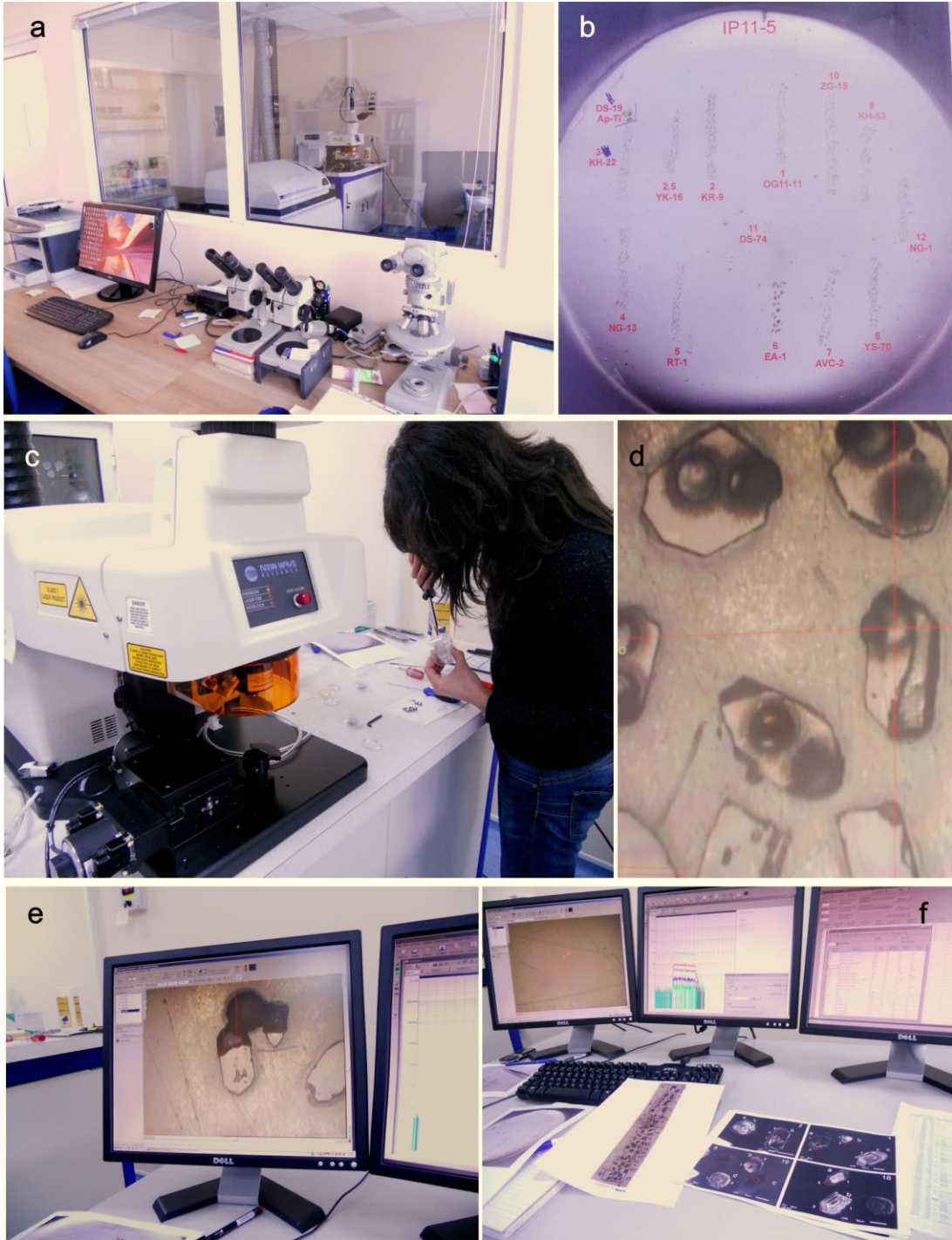
Şekil 3. 9: a. LA-ICP-MS tekniği ile Bulgar Bilimler Akademisi Laboratuvarlarında gerçekleştirilen yaş analizleri. b. "Mount" (zirkon örneklerinin sabitlendiği kap) içinde birçok farklı örneğe ait zirkon örnekleri. c. Dr. Elitsa Stefanova örnekleri LA-ICP-MS cihazına yerleştirirken. d ve e. Analizin takip edildiği ekranda zirkon taneleri üzerinde analiz edilecek noktanın seçimi. f. Daha önce elde edilmiş CL (Cathodoluminesans) görüntülerinden analiz edilecek zirkonun saptanması. |
