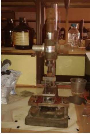
Şekil 3.3: VNA analizleri için kullanılan örnek hazırlama cihazı ve hazırlanan örnekler.
