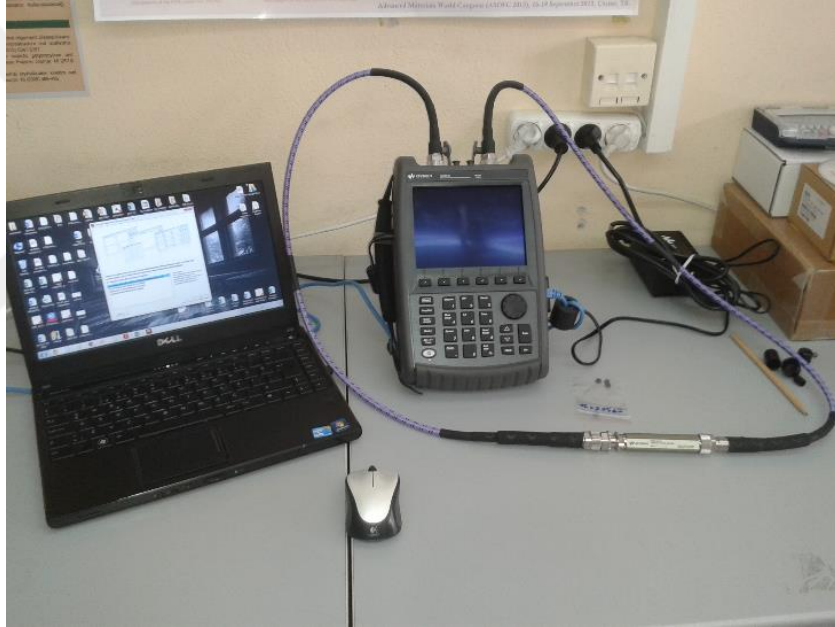
Şekil 3.2: Saçılma parametrelerinin ölçümünde kullanılan VNA ve ilgili test düzeneği.
