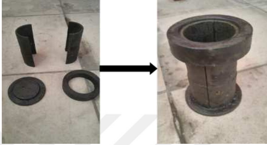
Şekil 3.13: 5 cm çapında ve 10 cm yüksekliğindeki silindir numune kalıpları.
