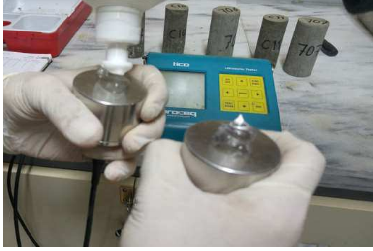
Şekil 3.17: Transdüserlerin (verici ve alıcı) ölçüm için hazırlanması.
