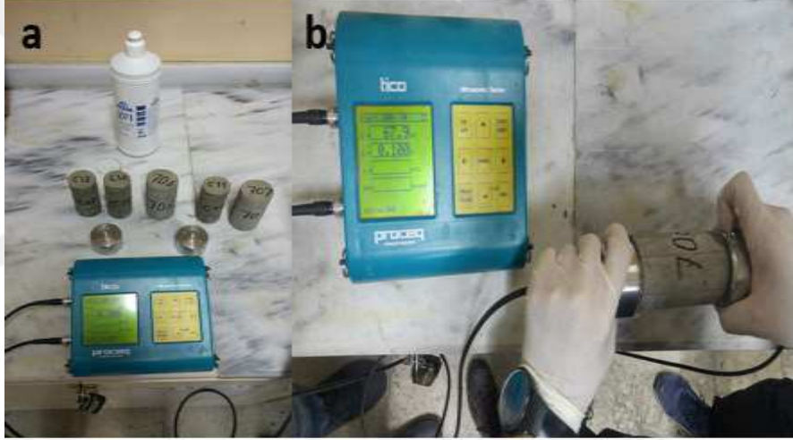
Şekil 3.16: Pundit deney cihazı (a) ve ölçümü (b).
