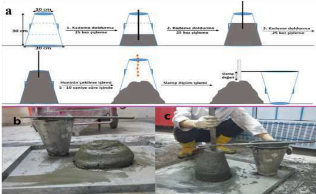
Şekil 3.11: Slamp metodolojisi (a), deney ekipmanları ve artık malzemesinin slamp ölçümü (b ve c).
