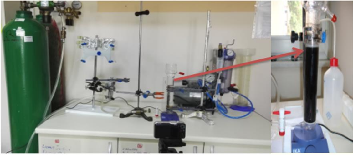
Şekil 3.11: Dinamik köpük stabilite deney düzeneği.
