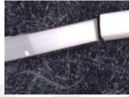
Şekil 4-6-2: B, Sağlıklı Dentin Yüzeylerinde Single Bond Universal Gruplarında Dentinde Koheziv Kopma (24 saat).
