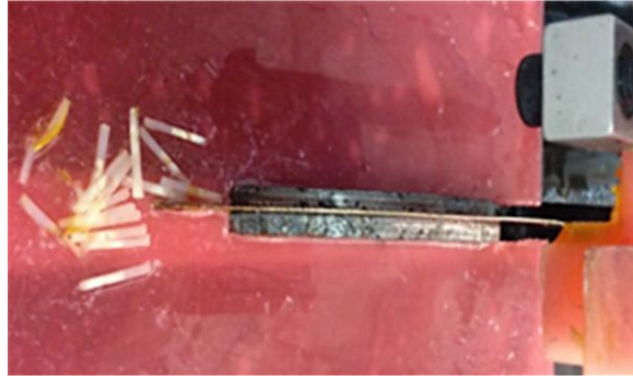
Şekil 3-13-3: 10 mm uzunlukta, 1 mm 2 kalınlıkta çubukların hazırlanması.
