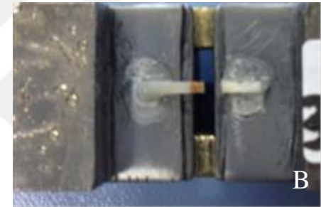
Şekil 3-21: B Çürükten etkilenmiş dentin çubuklarında dentinde koheziv tip kopma.
