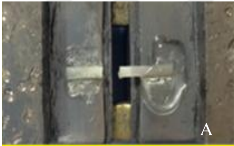
Şekil 3-21: A Sağlam dentin çubuklarında dentinde koheziv tip kopma.
