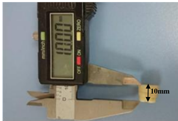
řekil 3-12: 5 mm'si dentin 5 mm'si kompozit olan rnek diř.
