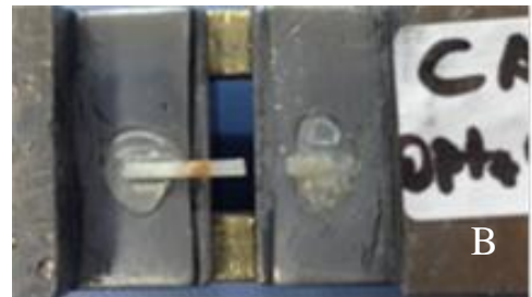
Şekil 3-22: B Çürükten etkilenmiş dentin örneklerinde kompozitte koheziv tip kopma.
