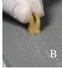
Şekil 3-6-1: B Yüzeyin 600 grit silikon karbid kâğıt ile zımparalanması.
