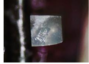
Şekil 4-6-1: C, Sağlıklı Dentin Yüzeylerinde Optibond FL Gruplarında Adeziv/Mixed Kopma (24 saat).
