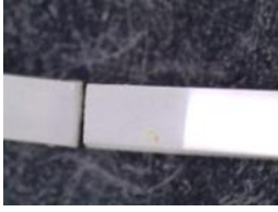
Şekil 4-6-1: A, Sağlıklı Dentin Yüzeylerinde Optibond FL Gruplarında Kompozitte Koheziv Kopma (24 saat).
