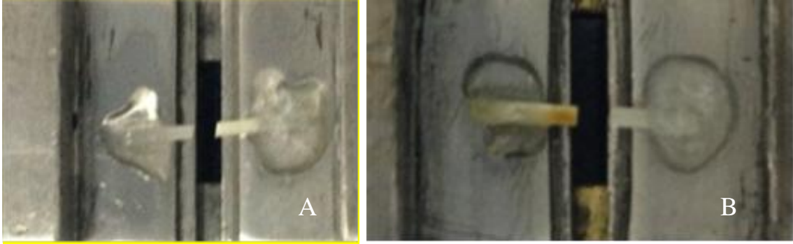
Şekil 3-20: A Sağlam dentin çubuklarında adeziv/miks tip kopma.
