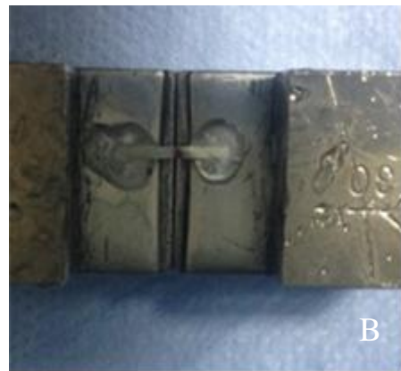
Şekil 3-15: B Çürükten etkilenmiş dentin çubuklarının siyanoakrilat yapıştırıcı ile sabitlenmesi.
