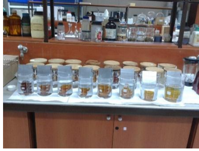
Şekil 3.16: Su Dayanımı Test Sistemi.
