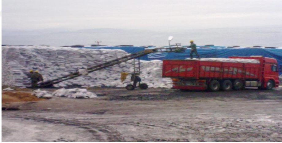
Şekil 4.42: Stok sahasında kamyonlara kömür yüklenirken görünüm.
