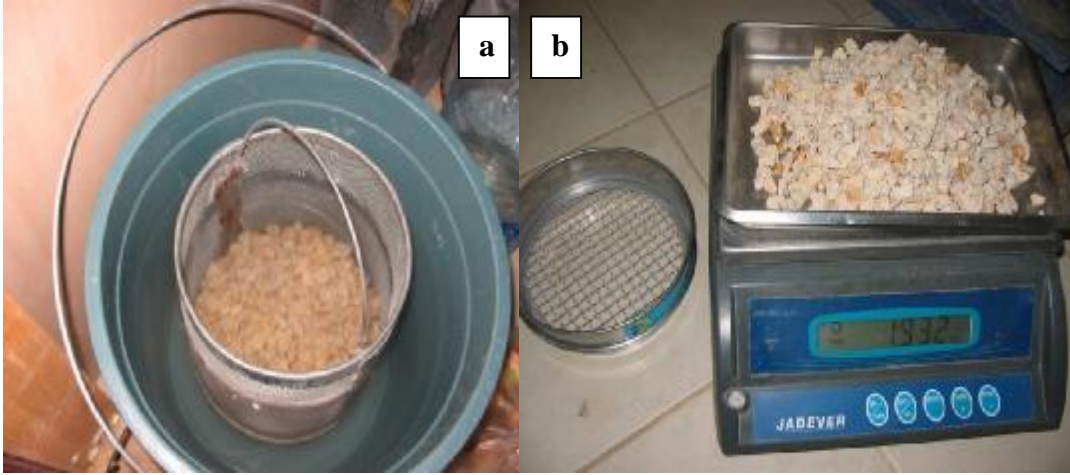
Şekil 3.6. Sodyum Sülfat ile Donma-çözünme kaybı
