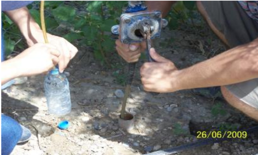
Şekil 3.7. El pompası yardımıyla taban suyu gözlem kuyusundan taban suyu örnekleme
