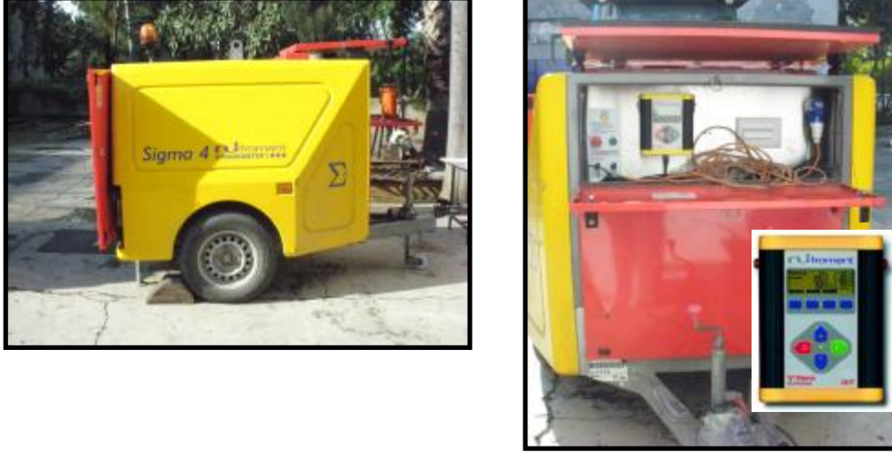
Şekil 3.4. Elektriksel dinamometre ve kumanda paneli
