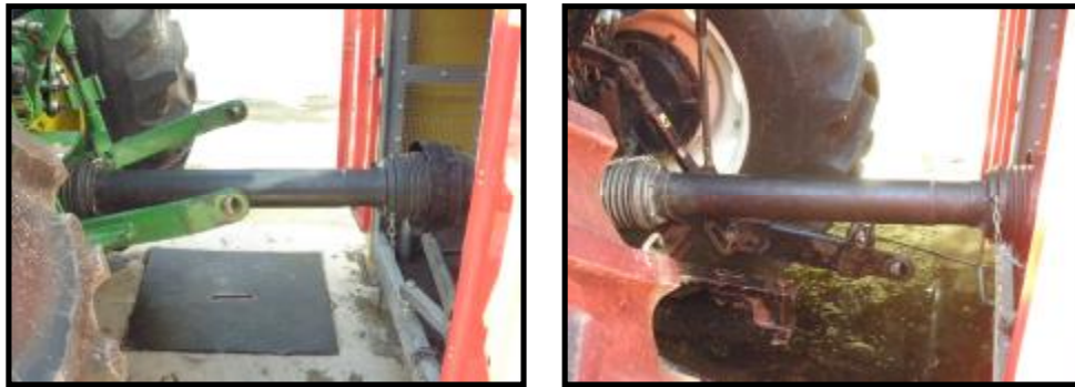
Şekil 3.7. Traktörlerin kuyruk mili bağlantıları
