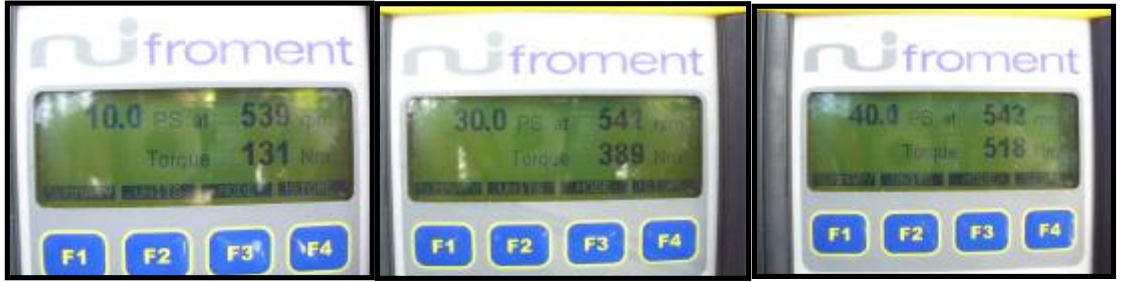
Şekil 3.13. Dinamometre ölçümlerinden örnekler
