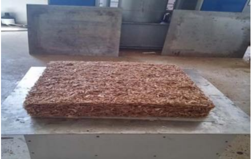
Şekil 2.28: Levha taslağı (serme işlemi).
