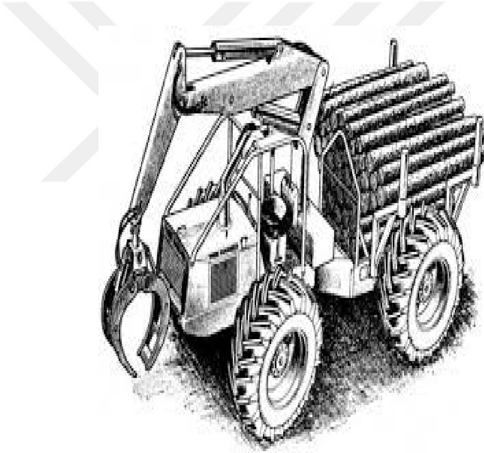
Şekil 1.6: Ahşap taşıyıcı vinçli kamyon. 6
