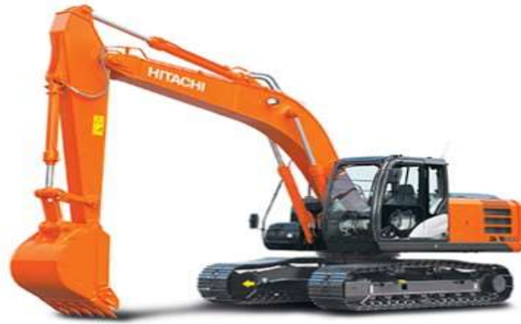
Şekil 1.1: Makinelerin kayma riski olduğu tepelik bölgelerde kullanılan paletli ekskavatör. 1
