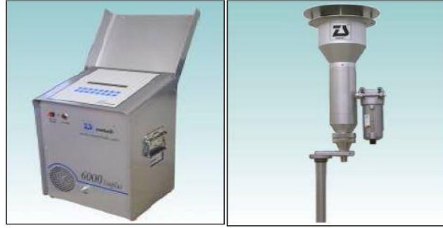
Şekil 3.4: Zambelli ISO Plus 6000 hava örnekleycisi pompa ve başlığı.
