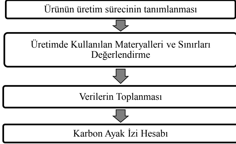
Şekil 3.2: Tesiste ürün karbon ayak izi belirleme çalışmasında takip edilen temel 4 aşama.
