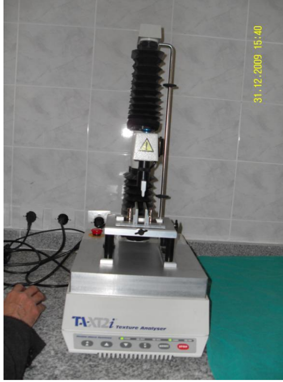
Resim.10. Biyomekanik tespit yapılan cihaz
