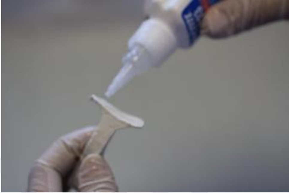
Şekil 3-6: Stentin kol kısmının yapıştırıcı yardımıyla sabitlenmesi
