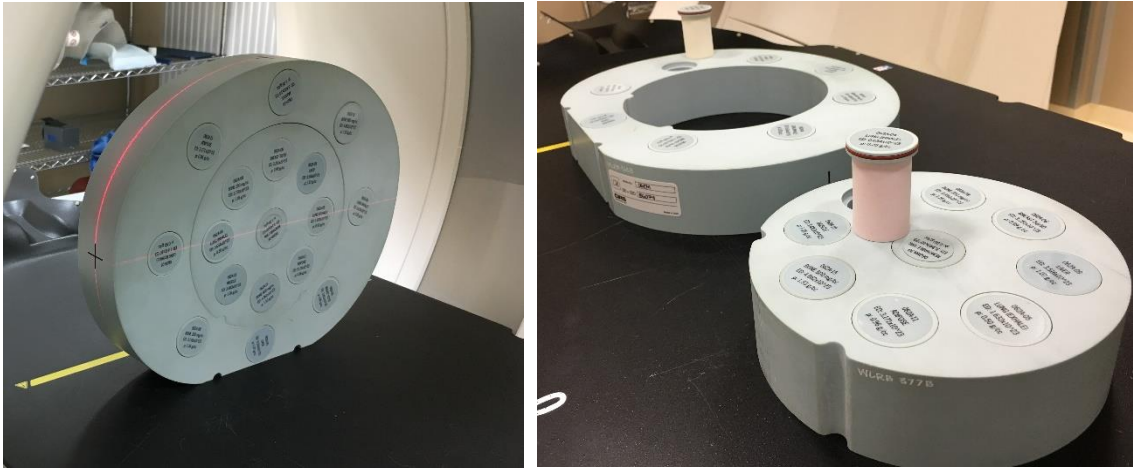
Şekil 3.4: CCB'de kullanılan 062M Model elektron yoğunluk fantomu 4 .
