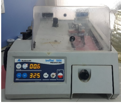
Şekil 14 : IsoMet hassas kesim cihazı
