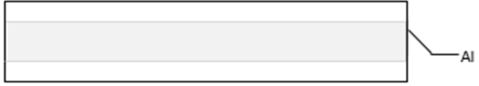
Şekil 3.4: Cam taşıyıcı üzerinde Al kullanılarak kaplanan bir alt elektrot.
