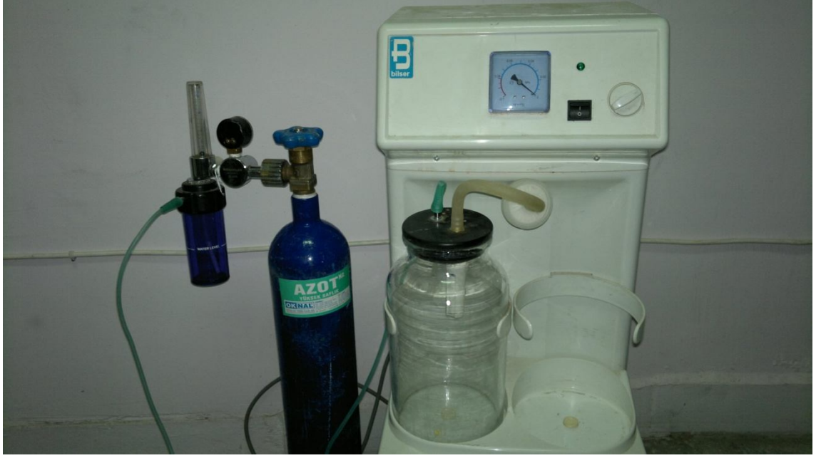
Şekil 3.2 Hipoksi oluşturmada kullanılan aspiratör ve nitrojen gazı.
