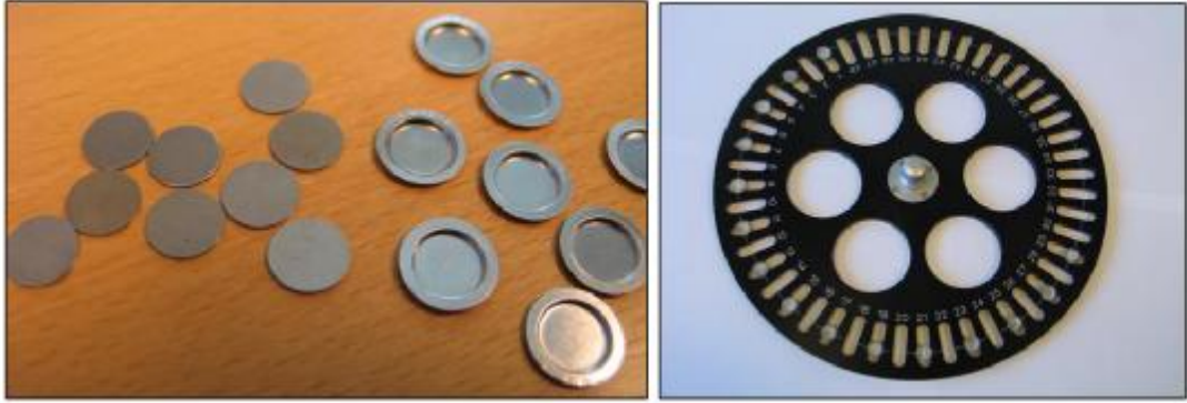
Şekil 4.3. Deneylerde kullanılan 48 örnek haznesine sahip döner tabla ile örneklerin yerleştirildiği kenarlıklı ve kenarlıksız diskler
