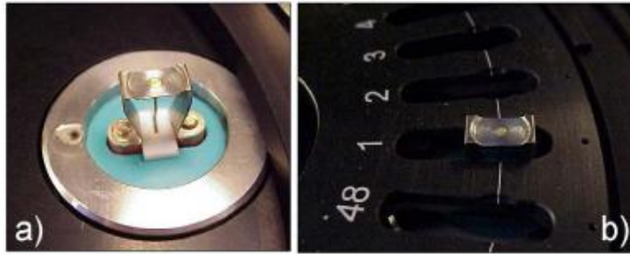
Şekil 4.12. Isıtma biriminin a) ölçüme hazır pozisyonundaki b) örnek tablası yerinde iken görüntüsü
