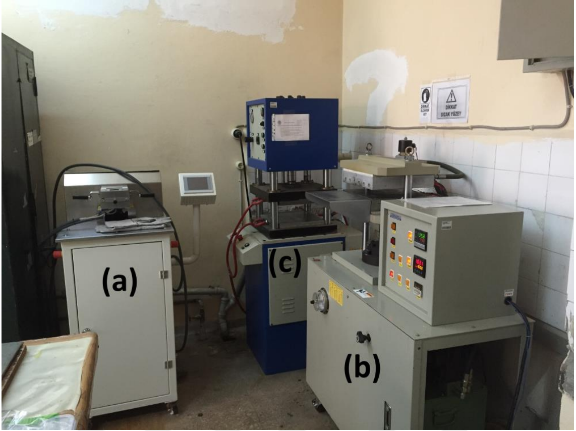
Şekil 3.6: Ekstrüzyon için kullanılan cihazlar a) Karıştırıcı b) Isıticılı Pres c) Soğutuculu pres.
