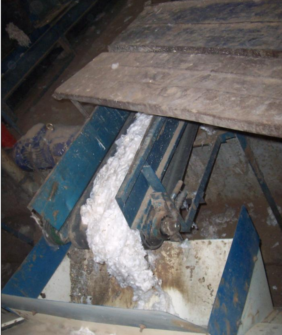
Şekil 4.4. Rollergin tipi çırçır makinesinden işlenmiş pamuğun balya ünitesine gidişi
