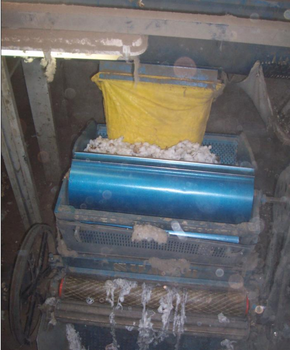
Şekil 4.3. İşletim sırasındaki rollergin tipi çırçır makinesinden pamuğun çıkışı
