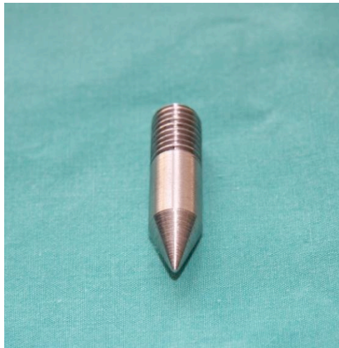
Şekil 3-17: Biaksiyel bükülme testi için kullanılan üst hareketli parça
