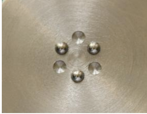
Şekil 3-16: Biaksiyel bükülme testi için kullanılan alt sabit parça
