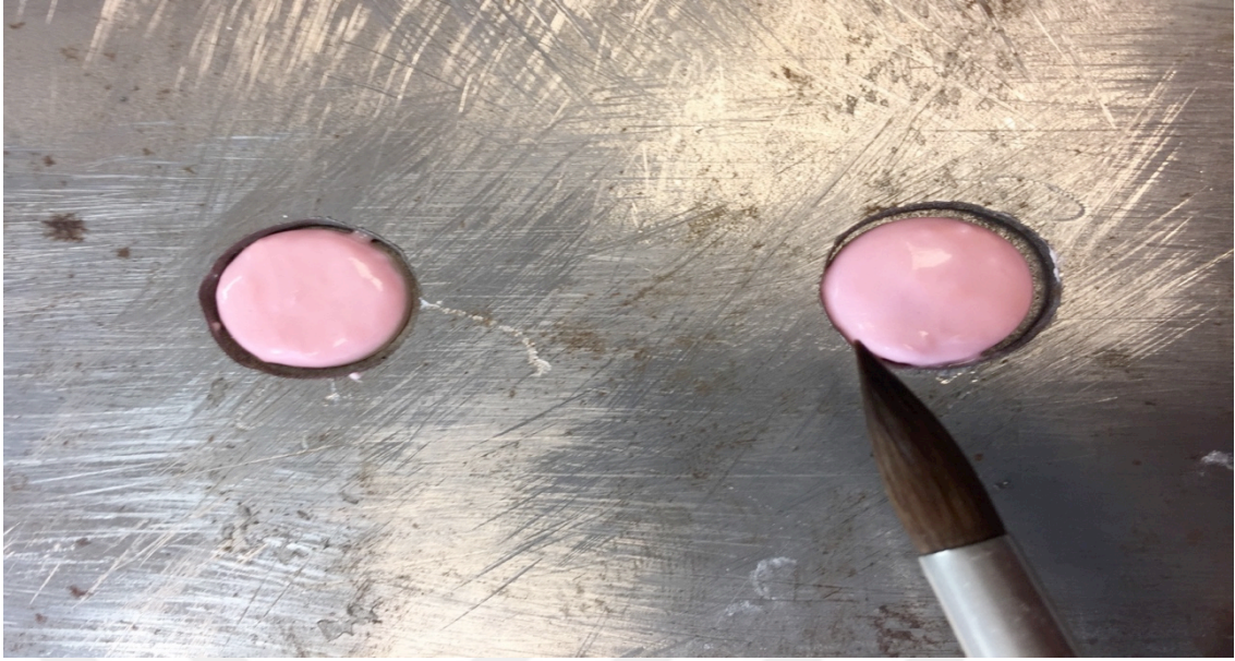
Şekil 3-10: Standart üstyapı porselen kalınlığı elde etmek amacıyla kullanılan paslanmaz çelik kalıp
