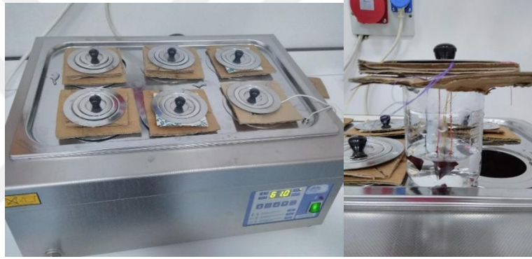
Şekil 3.20: LR-115 filmlerinin NaOH çözeltisi içinde banyo süreci.
