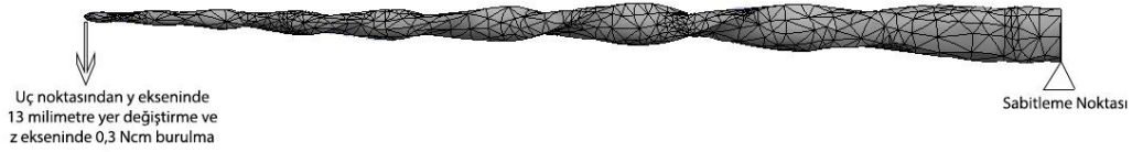
Şekil 3-20: Aletlere uygulanan bükülme + burulma testi.
