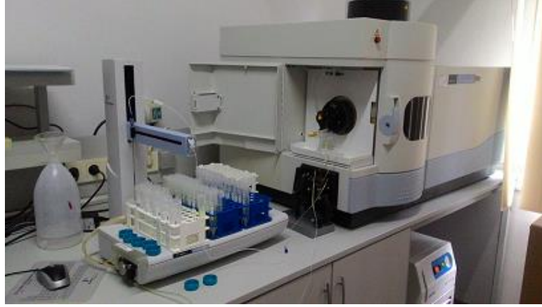
Şekil 3.10 ICP-OES 7000 DV( İndüktif Eşleşmiş Plazma Optik Emisyon Spektroskopisi) cihazı (İstanbul Üniversitesi-Cerrahpaşa, Orman Fakültesi).
