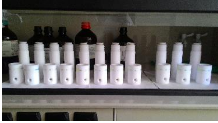
Şekil 3.7 Ağır metal analizleri için hazırlanan örnekler.
