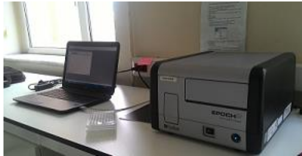
Şekil 3.11 BioTek Epoch2 Mikropate Spektrofotometre Cihazı.
