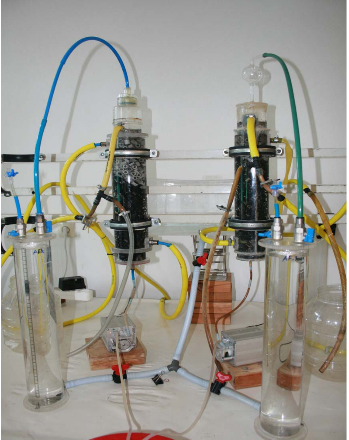
Şekil 3.2. Anaerobik filtre reaktörler
