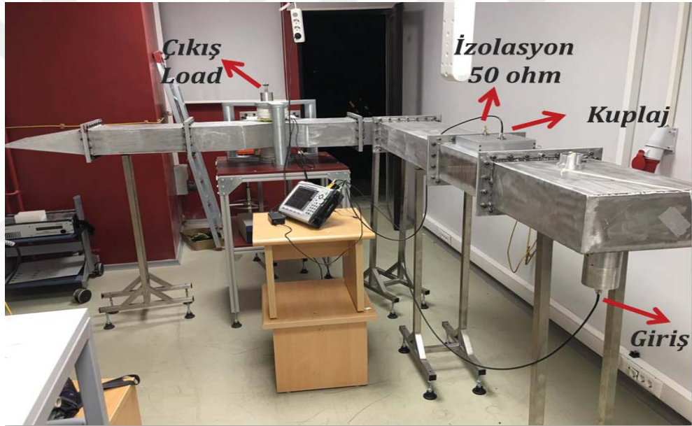
Şekil 4.29: Yansıyan dalga için bağdaştırıcı ölçüm düzeneği.
