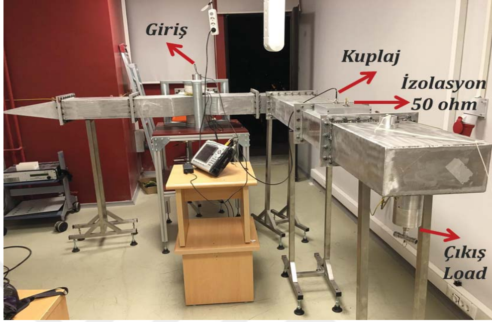
Şekil 4.22: İlerleyen dalga için bağdaştırıcı ölçüm düzeneği.
