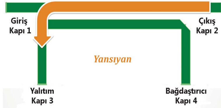
Şekil 4.32: Yalıtım ölçüm şeması S_{32} .
