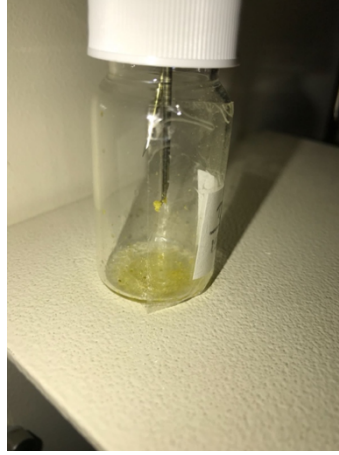
Şekil 3.4: Süperkritik ekstraksiyon işlemi sonucunda vialde toplanan ekstrakt.
