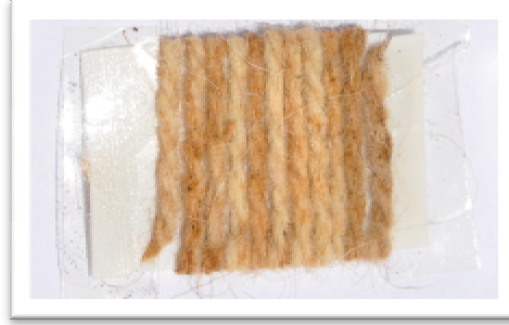
Şekil 4.6. \text{Sn}^{2+} mordanlı ceviz kabuğu ile \text{scCO}_2 çözücü ortamında boyanmış ipliğin görüntüsü
