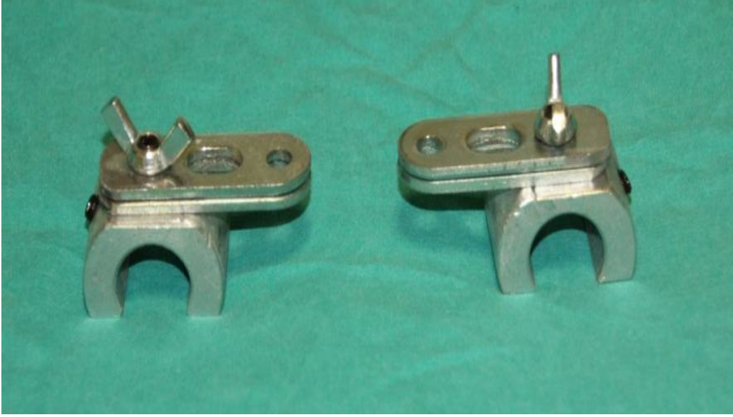
Fotoğraf 6 : Özel tutucu klempler
