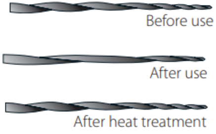
Şekil 2.2-5: Kullanım sonrası bozulan spiral yapının eski haline dönmesi (Coltene Endo 2014)
