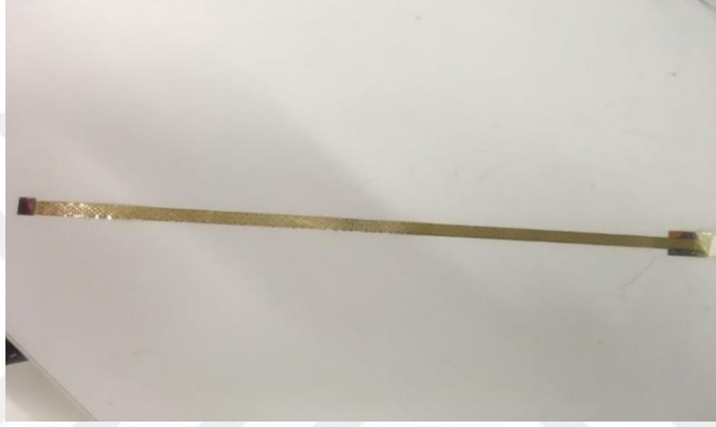
Şekil 2.16: Çipe bağlanmış mikrokabloya bir örnek.
