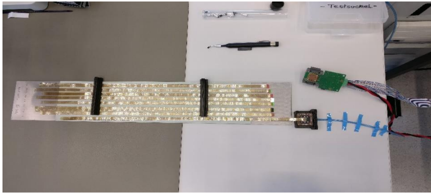
Şekil 3.33: STS-XYTER ASIC ve mikrokablo arasındaki bağlantı testi.
