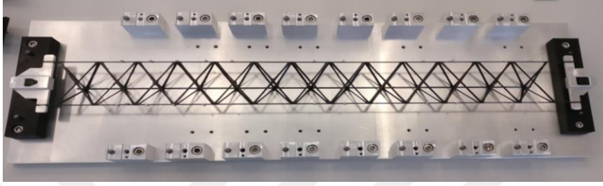
Şekil 3.27: Mini STS için merdiven örneği.
