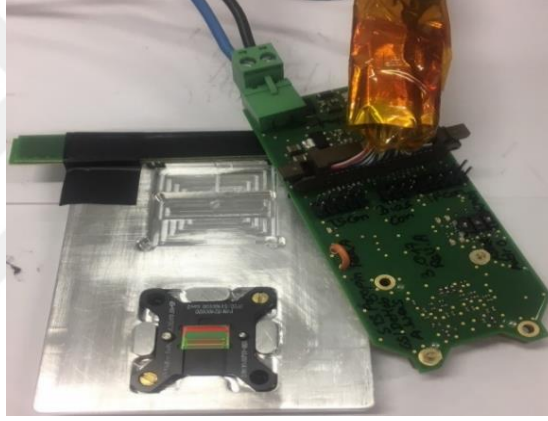
Şekil 3.7: Pogo-pin test istasyonunun eski versiyonu.
