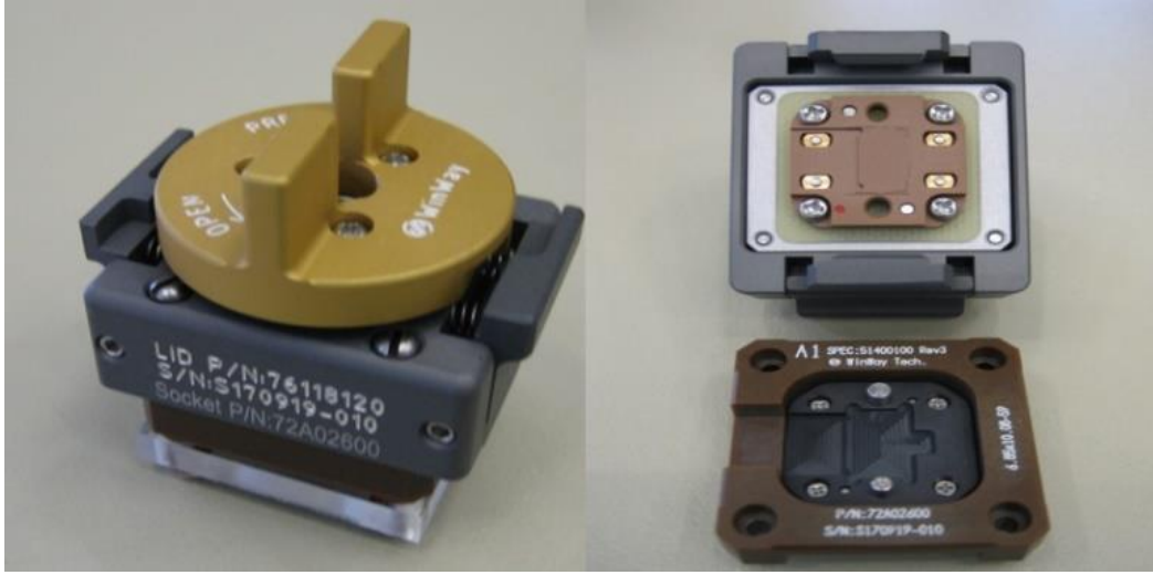
Şekil 3.9: Pogo-pin test istasyonunun yeni versiyonu.
