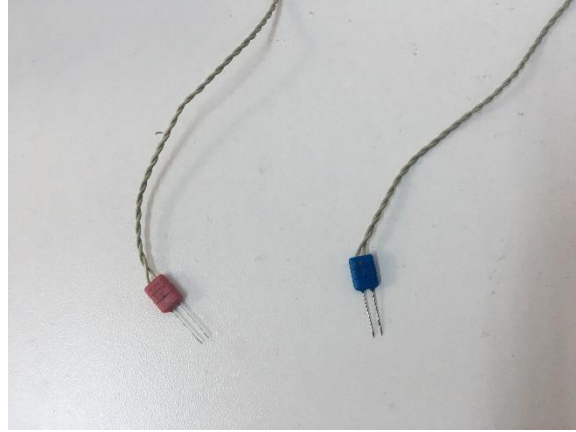
Resim 4: EMG yapımında kullanılan uyarıcı ve kayıtlayıcı elektrotlar
