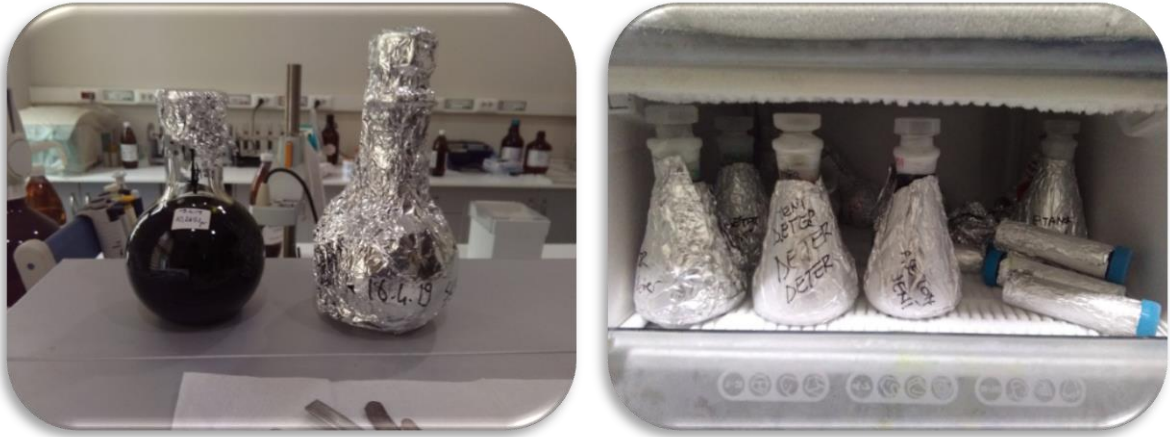
Şekil 3.17: Ekstraktların folyo ile sarılarak derin dondurucuda (-28°C) muhafaza edilmesi
