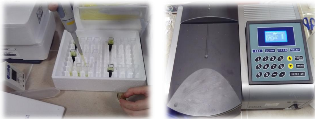
Şekil 3.46: Küvetteki ekstrakt içeren solüsyonların spektrofotometrede ölçümleri.
