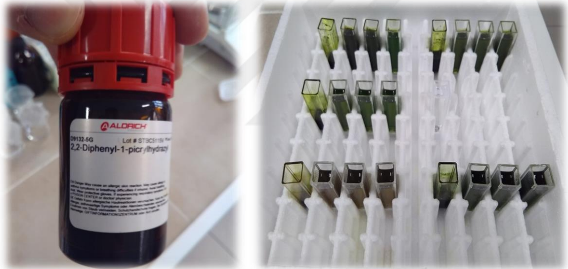
Şekil 3.47: DPPH reaktifi ve spektrofotometrik ölçüm öncesi küvetlerdeki ekstraktlar.
