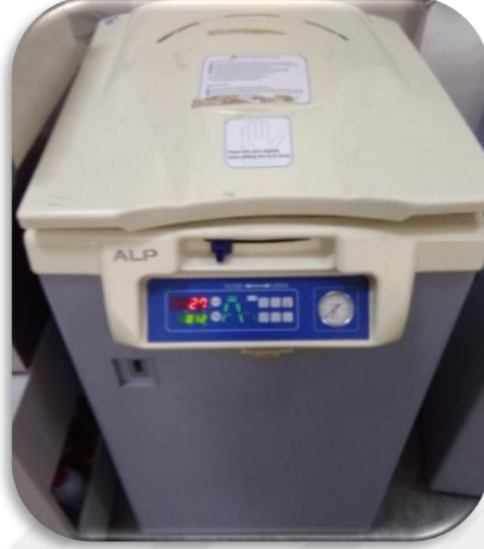
Şekil 3.35: Salamlara ısıl işlemin uygulandığı otoklav.
