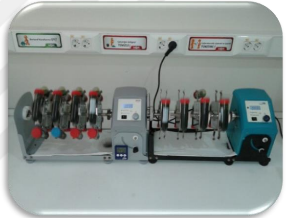
Şekil 3.3: İlk deneme çalışmaları; Solvent ile ekstraksiyon işlemi (Aralıksız 48 saat 35 RPM).
