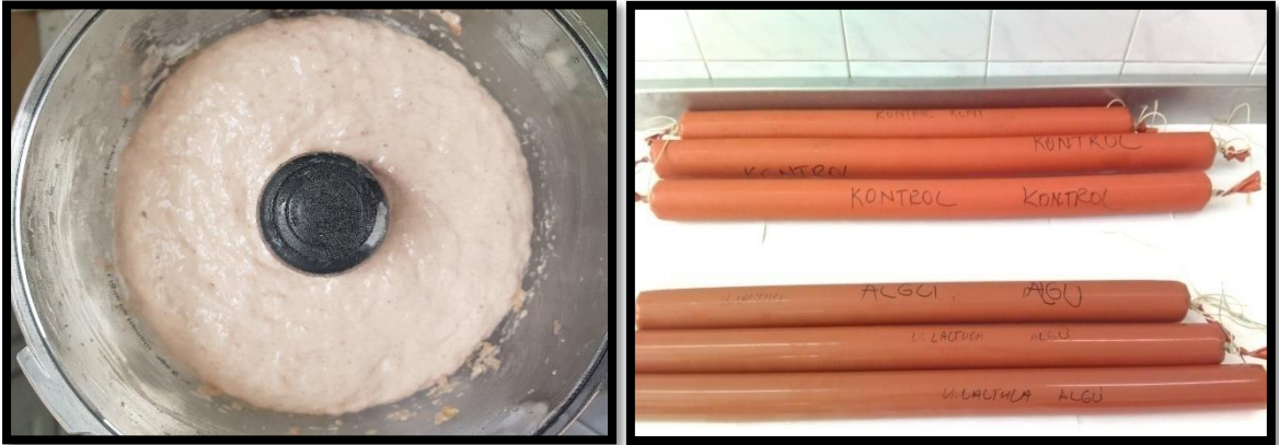
Şekil 3.34: Pişirme işlemi öncesi kılıflara dolmaları yapılmış salamlar.
