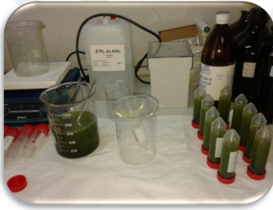
Şekil 3.3: İlk deneme çalışmaları; Solvent ile ekstraksiyon işlemi (Aralıksız 48 saat 35 RPM).
