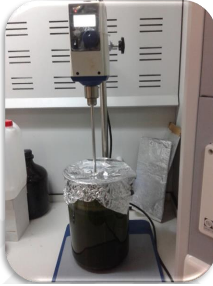
Şekil 3.12: Ekstraksiyon sıvısına otomatik karıştırma işlemi uygulanması.
