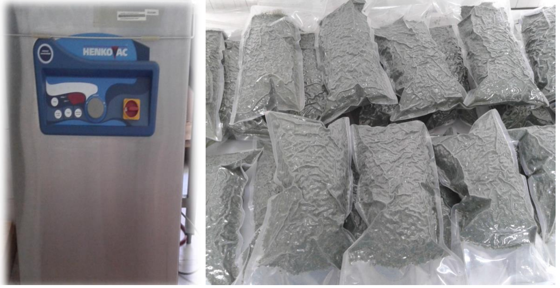
Şekil 3.8: Vakum cihazı ve deniz marullarının vakum ambalajlanması sonrası görünümü. |
