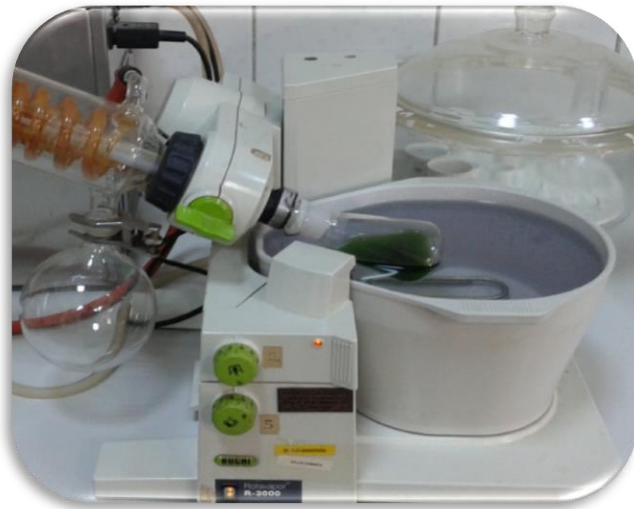
Şekil 3.4: Ana çalışma öncesi ilk saf ekstraktın evaporatörde elde edilmesi.
