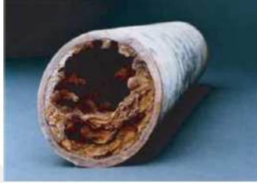
Şekil 2.3: MIC korozyonundan etkilenen boru hattı (Popoola ve diğ., 2013).
