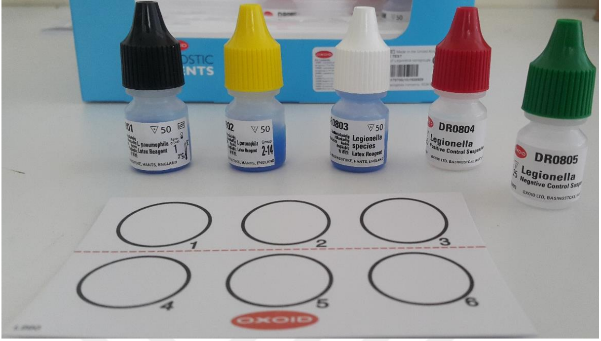
Şekil 4. L. pneumophila serogruplandırma için kullanılacak olan Latex Test Kitinin içeriği
