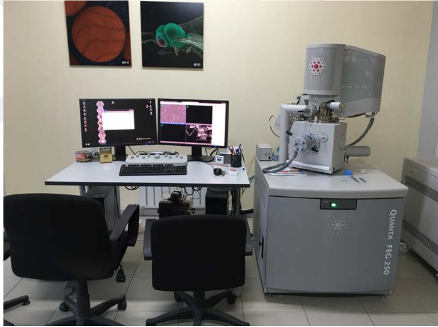
Şekil 3-18: Taramalı Elektron Mikroskobu ve EDS cihazı
