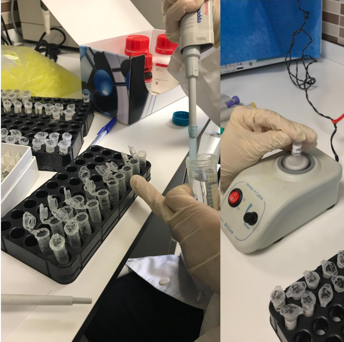
Şekil 3.23: Örneklerle çözeltilerin otomatik pipetle eklenmesi, vorteksle karıştırılması
