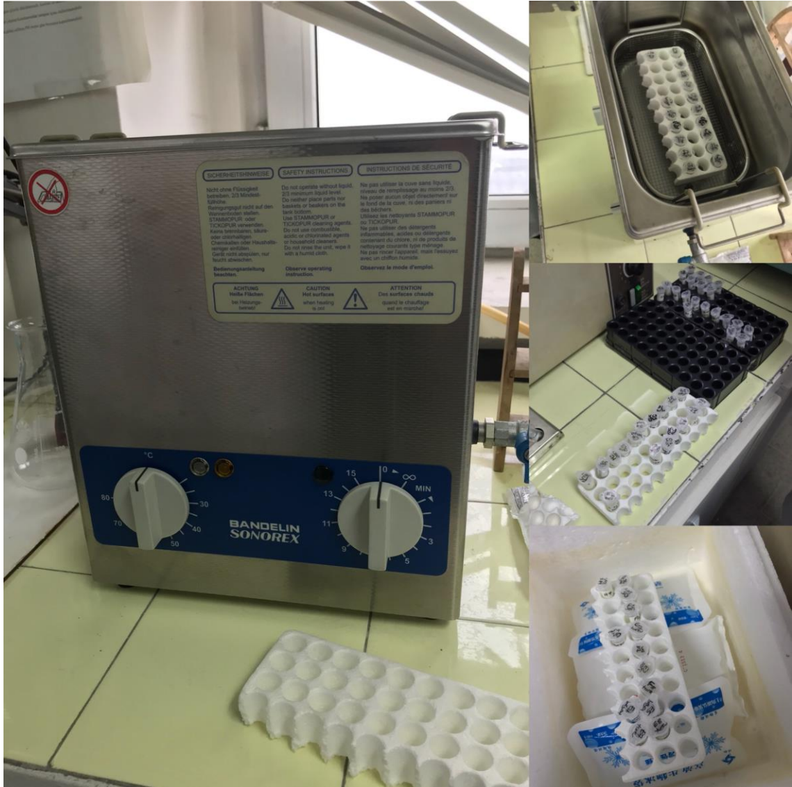
Şekil 3.15: Tükürük ve plak örneklerine eksternal sonikasyon uygulanması, buz üzerinde soğutma
