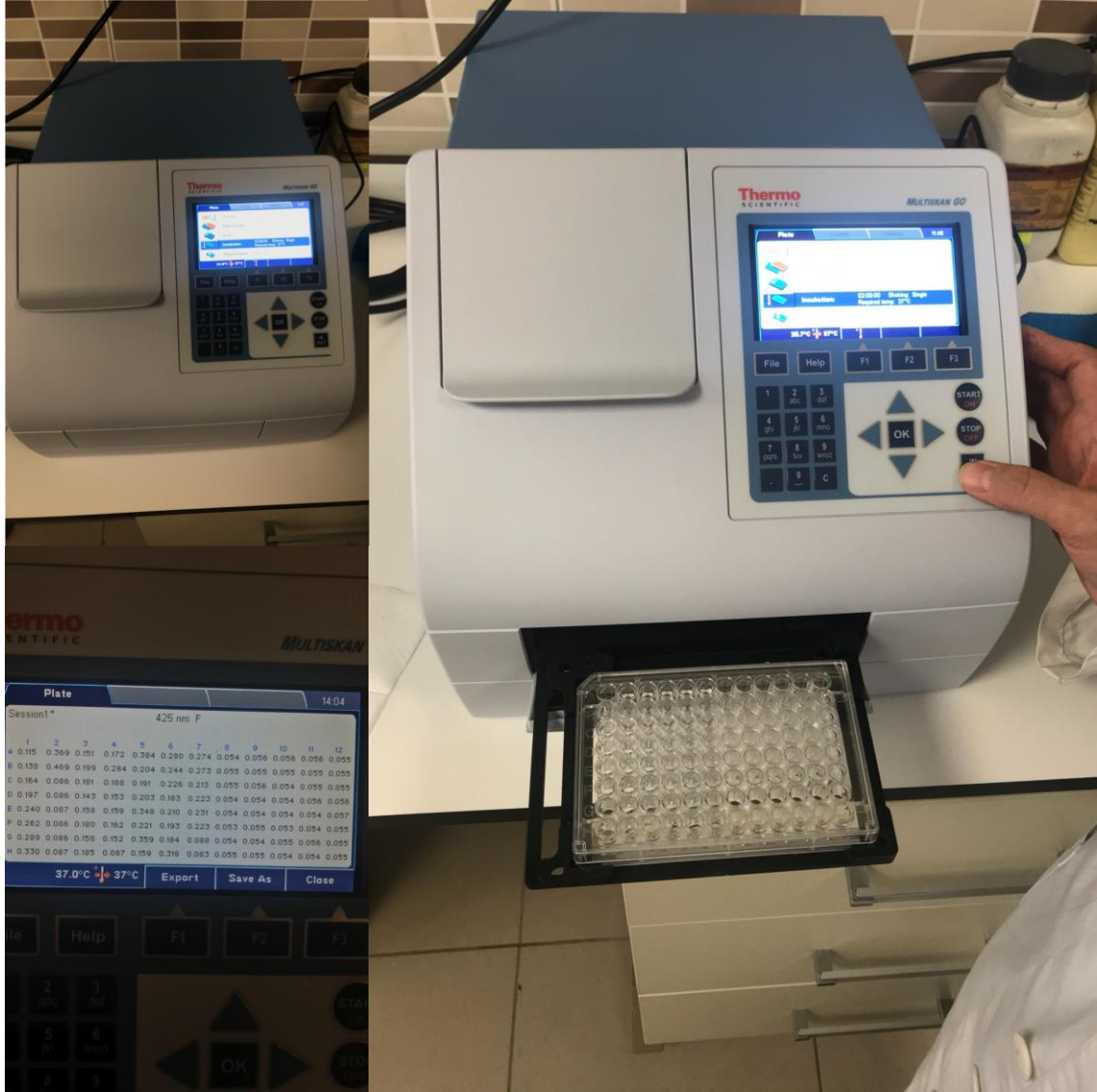
Şekil 3.26: Spektrofotometrede 425 nm’ de absorbanların okunması
