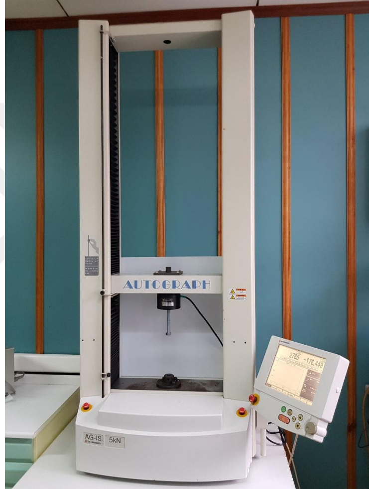
řekil 3.15: Deneyin gerekleřtirildięi servohidrolik test cihazı (Universal Autograph AGS®, Shimadzu Scientific Instruments, Kyoto, Japonya)
