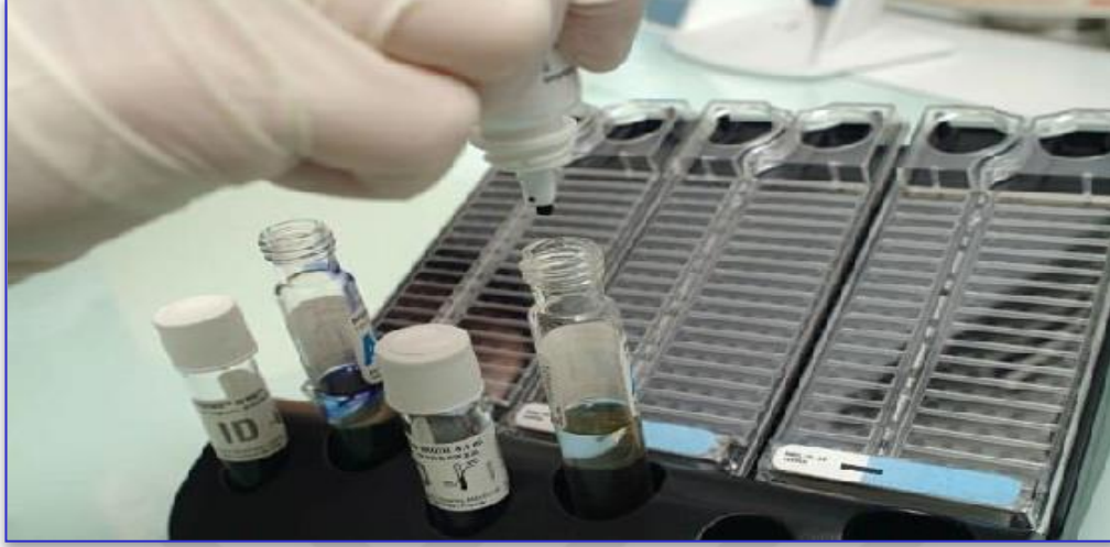
Şekil 17. AST indikatör solüsyonunun damlatılması.
