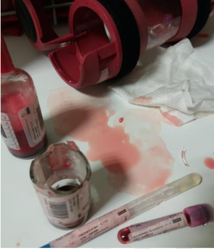
Şekil 35. Pnömatikte kırılan numuneler.
