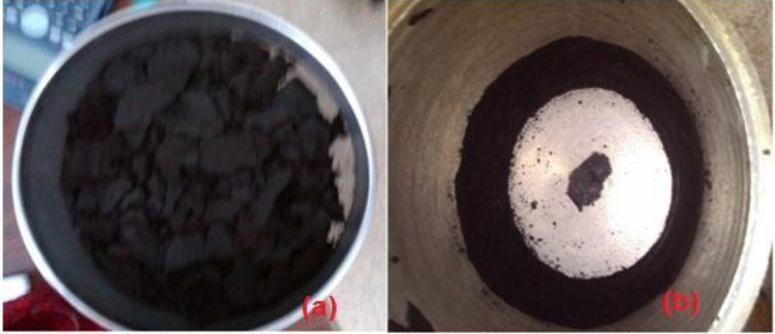
Şekil 4.12 (a) Öğütme işlemi sonucunda +1 mm elek üstü kömür numuneleri (b) öğütücü haznenin görüntüsü
