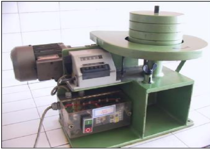
Şekil 3.4. Hardgrove deney aygıtı (İsdemir, 2010)
