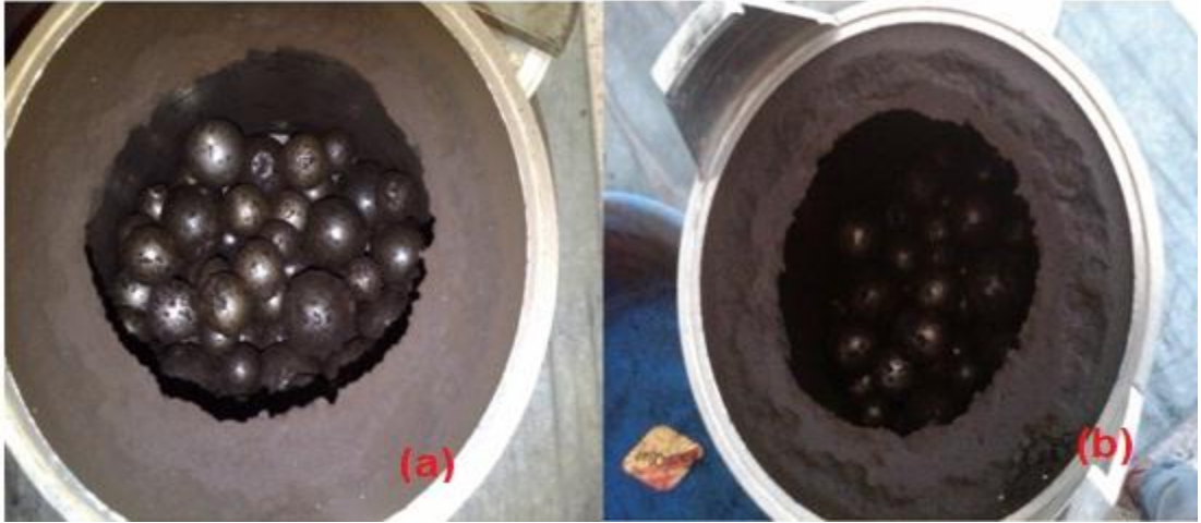
Şekil 4.11 (a) Nem içeriği %30’dan fazla olan kömür numunesinin öğütülmesi sonucu öğütücü haznenin görüntüsü (b) Nem içeriği %30’dan fazla olan kömür numunesinin öğütülmesi sonucu öğütücü haznenin görüntüsü
