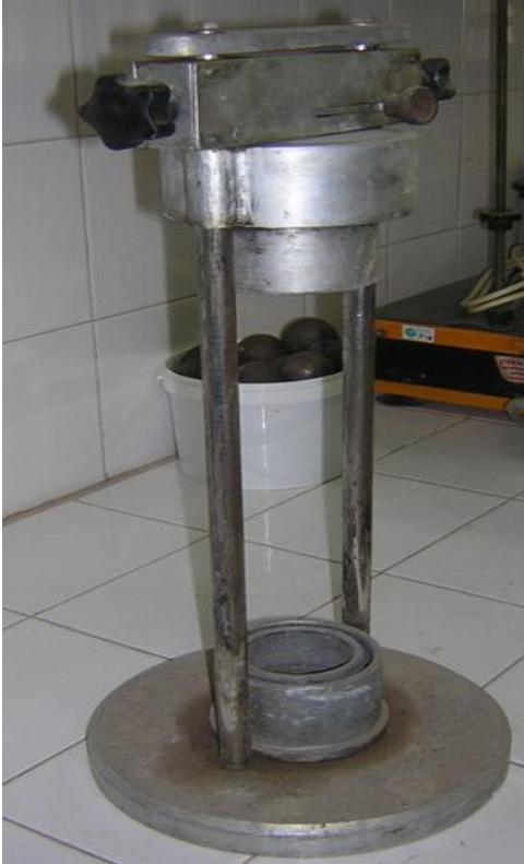
Şekil 3.6. Düzeltilmiş darbe dayanım deneyi aygıtı (Ural, 1999)
