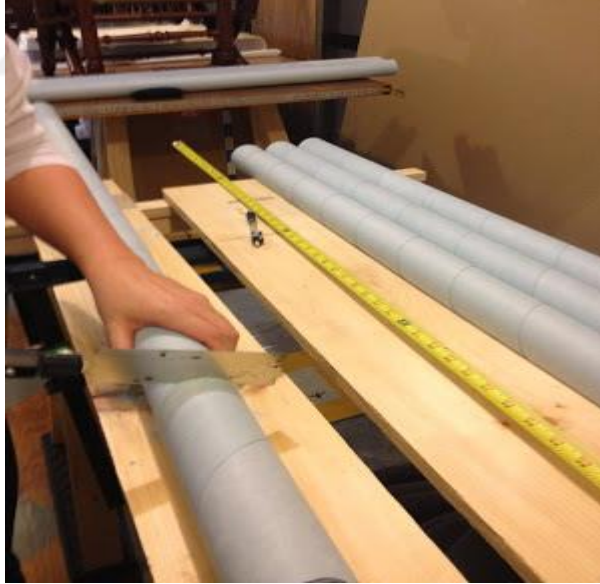
Şekil 3.5: Büyük haritalar için Rolling yöntemi ligninsiz borular kullanarak (Klug Conservation, 2019)
