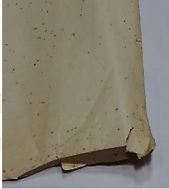
Fotoğraf 3.5 : Kenarda kırışıklık oluşumu yanlış depolama nedeniyle(Alyasin, 2019).
