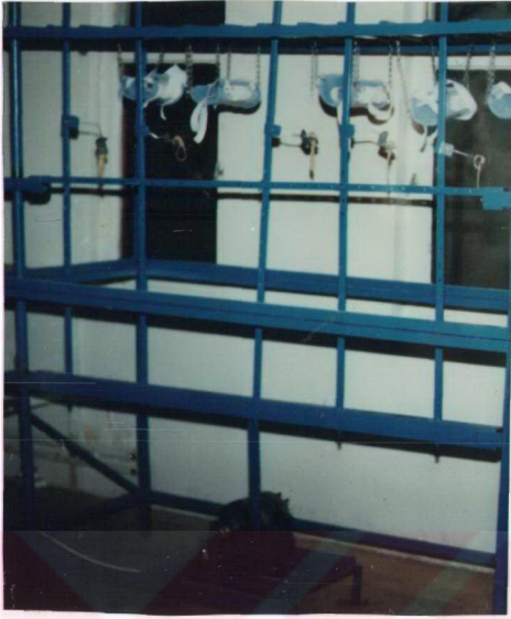
Resim 1: Tavşanlara Devamlı Pasif Hareket verilmesi için tasarlanan cihazın gösterilmesi
